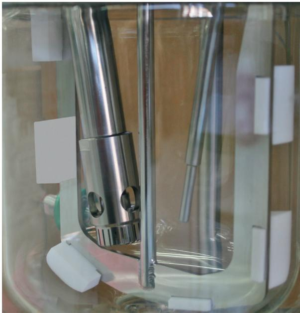
分散刀头, 带PTFE刮片的锚式搅拌器和温度传感器
